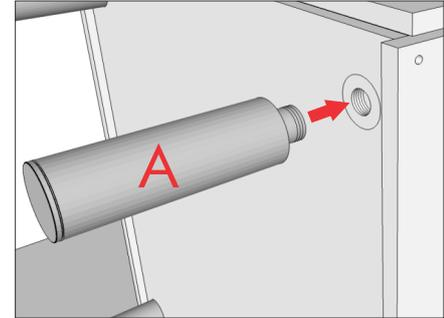
Detalhe fixação do pé plástico com rosca (A) na base inferior.
